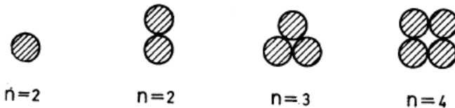
Slika 138/1 Dopušteni načini grupisanja armature u svežnjeve, prema BAB 87
